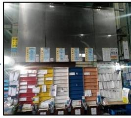
①伝票コーナーの上側の空間が空いていたので、工場の柱(H鋼)と鉄板を溶接し、見える化空間を増やしました。by比嘉幸助
