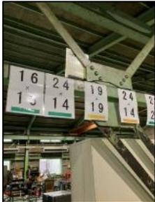
③原管の配置図はあるが、新人には分かりにくかった。そこで、原管後方の鉄骨にサイズ表記した看板を取り付け、遠くからでも見えるようにした。by飯盛仁志
