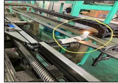
②今まで当たり当たっているかを音だけで判断していましたが、今回、リミットスイッチに電球を取り付けました。音だけでなく、光で確認してダブルチェックできるようにしました。by武田勇・クエット
