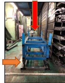
④レールがクレーン南手際の中心から少し南に寄っていました。溶接を外し、レールをクレーンの中心に動かしました。レールがクレーンの中心に来たことで、クレーンで材料を載せる際、より安全な作業ができるようになりました。(by 川中)
