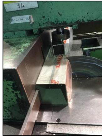
④SUS角パイプ 100x100x3.0を丸鋸切断しています。最近、SUS切断用の鋸刃が見つかりました。今度試してみます。(；´Д`)スバラシイ
