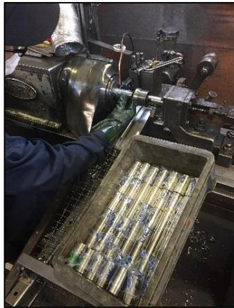
③SUS丸パイプ 32x2.0 を旋盤切断しています。SUSは硬くて旋盤で切りにくいのですが、熟練の技です。ヽ[´Д`]ノスゴイ
