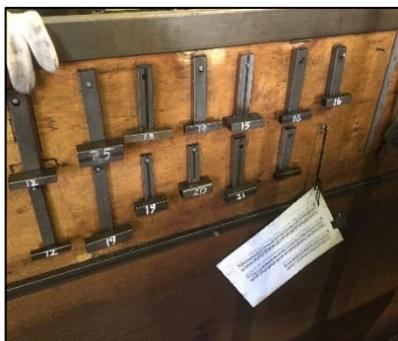
③丸鋸45°切断の時に使う当たりサイズを記入、片端に穴をあけて釘で吊り下げています。3S活動実施中。
