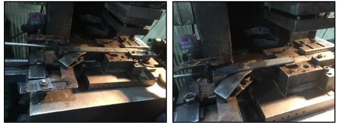
②フラットバー切断の受け方にかなりの工夫をしています、[°Д]ノスコイ
