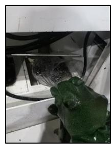
⑤丸鋸タンク内の切粉掃除を今まで網ですくっていましたが、ペットボトルを切ってタンク内に仕込みました。ペットボトルに穴をあけ、切削油が逃げるようになっています。これで掃除が楽になります。by佐多良太
