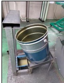
③今まで切断切粉をそのままスクラップのバツカンに捨てていたが、たまに切削油が漏れ、床を汚すことがあった。そこでペール缶の底に穴をあけ、百均で買った茶こしを置き、油だけが落ちるようにしました。by川崎健史・チャンスアンテイン
