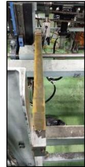
②丸パイプ切断機の原管台が鉄なので、置いた弾みで凹んだりする可能性があった。そこで台に緩衝材を貼り付けることにしました。by山口雅史
