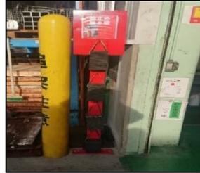
③残材を使って、トラックの輪止めを引っかけるフックを製作しました。by比嘉 幸助
