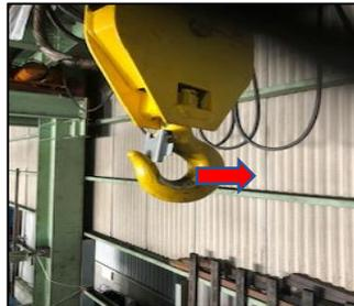
④本社1F 中央棟奥側のクレーンのフック止めがなくなっており、危険でした。新しくフック止めを取り付けすることで、安全に作業ができるようになりました！！by青松浩司
