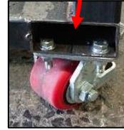
②原管移動用台車のキャスターを回転式で採用したが、左右に振られるなど進行が定まらないので、固定式キャスターに変更した。by辻、比嘉
