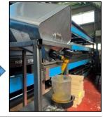
①ドラム缶の縁(ふち)まで穴が延びてきたので、安全な 位置で新たに穴を開けました。by中川、野上、新見 ②腰を折って入れていた切削液を、立ったまま入れることができるように一斗缶専用の台を作り、蛇口を取り付けました。by上岡浩二
