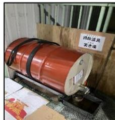
⑤今まで防錆油をポンプで吸い上げていたが、ドラム缶を横に倒し蛇口を取り付けたことで、作業時間の短縮につながった。by武田勇
