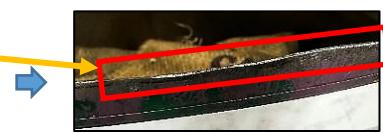
②ドラム缶を半分に溶断して麻袋入れにしているが、切断面のバリ処理が不十分だったので、麻袋がバリに引っ掛かったり、怪我をする恐れがあった。今回、バリ処理をすることで、作業性と安全性が向上した。by辻和樹
