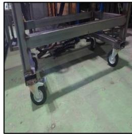
③台車のキャスターが壊れたので、サイズも大きくして交換しました。重たい製品も運べるようになって効率が上がりました。by宇野俊一・チャンスアンニャン
