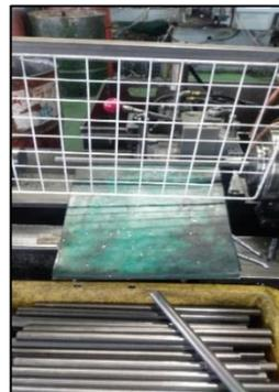
④過去に旋盤自動切断機で指を挟む事故がありました。短い長さを切断する際、切りが溜まり、それを慌てて取ろうとしたときに事故は起きました。今回、カバーを付けたことで、指の進入を防ぎ、挟んでしまう危険をなくしました。by武田勇、ニャン・クエット・フィー
