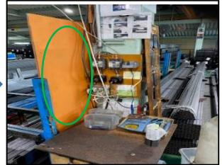
②プレス機の前管台近くに、コンセント類や電源系統があります。霧吹きで防錆油を吹きつけ、ウエスで拭き取る作業時、コンセント付近は特に注意を払わなければなりません。そこで、壁を作り、電源系統を保護。漏電や故障の防止ができた上、コンセント周りの掃除の手間が省けました。byチャン・イエン・ピン
