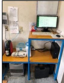
①事務所のPC新システム移行により、使わなくなったパソコンを本社工場に1台移設。2台体制にしました。パイプとコンパネで棚付きパソコン台を作成。パソコン内部の不要なデータを削除。共有フォルダやプリンターに接続。快適に作業できるようにしました。片方のパソコンでオーダー処理、もう一方で報告書作成などの作業ができるようになり、作業効率が上がりました。by川中剛
