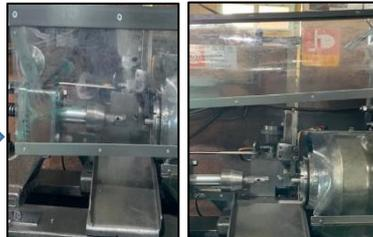
③旋盤切断時の怪我を防止するため、安全カバーを作成。刃の交換等、作業の邪魔にならないように可動式としました。by柴尾中宝
