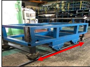
①材料を移動する台車の車輪幅が狭かったので、前後に車輪をつけました。これにより、作業の安全性が高まると共に、作業スピードが上がりました。by武田勇
