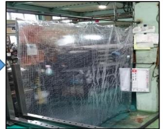
②隣接する旋盤と丸鋸の距離が近いので、丸鋸作業者がエアで切粉を吹くと、旋盤のチャックや製品に飛んでくることがあった。そこで切粉飛散防止のため、ビニールカーテンで仕切りました。フックで取り付けているので取り外しができます。by柴尾中宝
