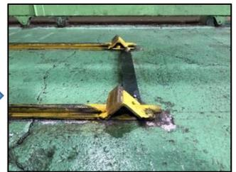
④本社2階北棟から南棟まで伸びるレールの車輪止めが簡易的で、台車がレールから落ちることがよくあり、原管等を載せている時に落ちると危険だった。アングルを溶接し、車輪が痛まないように樹脂製の緩衝材を張り付けて、車輪止めを取り付けました。また、注意喚起のために黄色く塗装しました。台車使用時に車輪が落ちる事を考えずに作業に集中できるようになった。(by 川中、ニヤン)
