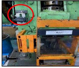
①プレス機で短い寸法を切断する際、計算上と実際に定尺から取れる本数が異なる場合があるため、数量カウンタをプレス機全台に取り付けました。これにより、短い寸法の本数間違いを防ぎます。by武知伸一
