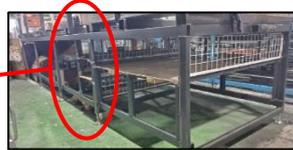
③原管台下のデッドスペースに引き出し付きの棚を設置しました。短管の同サイズ厚み違いを分別整理したので、今後、そのようなクレームは出しません。by梅木正敏&グエン・ヴァン・ジャウ
