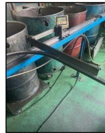
②曲げの後切り時、短管を探し万力で挟んで切っていた。それを適度な長さのフラットバーに穴を開け、ネジで当りに固定できるようにした。製品を切る度に短管を探していた手間がなくなり、作業時間を短縮できた。by広兼有翼&チャン・カイン・ホアン
