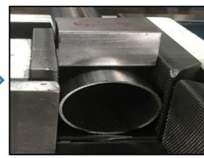
②APM(丸鋸)でφ63.5 を切断すると、バイスの締める力が強くて丸パイプが変形してしまうので、旋盤やトレンガー(丸鋸)で切断していたが、今回APMで切断できるように治具(短管使用)を作成し、変形を最少減に抑えて切断できるようにした。by岩田光央
