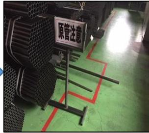
①原管が長すぎてどうしても飛び出してしまうので、注意喚起の札を設置しました。
