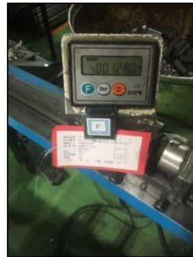
④ 切断機の寸法当たり下に荷札をクリップで止めて、長さ確認できるようにしました(・▽・)ナイス!
