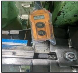
①昇降台のスイッチがむき出しで油が付着していた(安全パトロール時に発見)。漏電や故障の原因になるため、ビニールカバーをした。by武知伸一
