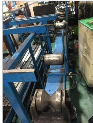
④平鉄切断用のローラーを着脱式にして、鋼管切断用V型ローラーに干渉しないようにしています(・▽・)ナイス!
