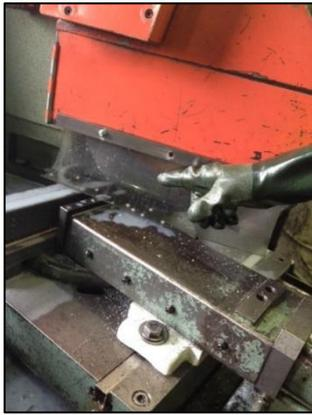
① 鋸刃に手が接触しないよう透明の硬質ビニールでカバーしました。
