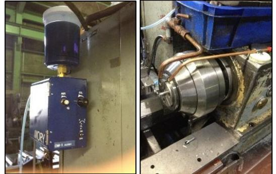
③丸パイプ切断機にミスト装置を設置し、切断しやすくしました。
