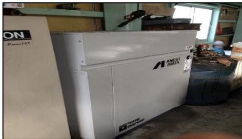
③第三工場に新たにコンプレッサーを導入しました。今までエア噴射力が弱く切粉を飛ばすのに10秒かっていたのが4～5秒に短縮しました。
